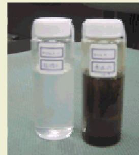
右は蒸気で高カロリー化した油(助燃剤として使用)。左は油から分離した水。
