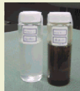
右は蒸気で高カロリー化した油(助燃剤として使用)。左は油から分離した水。
